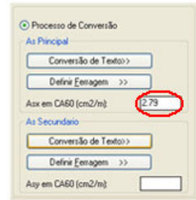
3- O valor da área de aço principal, em CA60, será mostrado abaixo dos botões.
