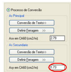
3- O valor da área de aço secundário, em CA60, será mostrado abaixo dos botões.
