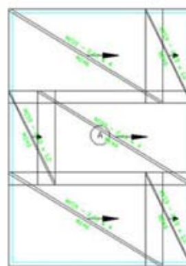
Paginação de Telas com Armadura Composta
