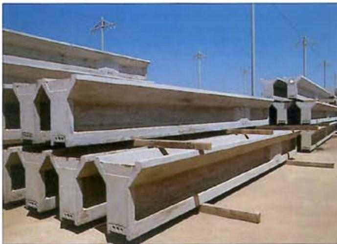
**Fig. 6 - Vigas-calhas pré-fabricadas no pátio de estocagem**
