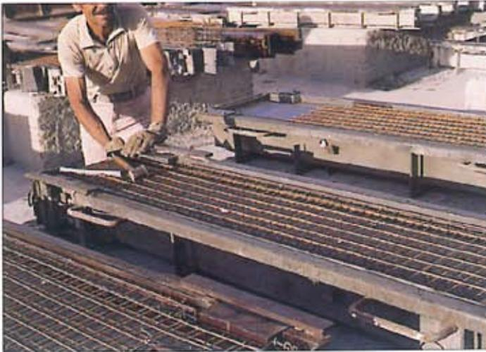
**Fig. 9 - Produção de elementos para construção de canais de drenagem: aspecto da montagem da armadura de telas soldadas na fôrma**
