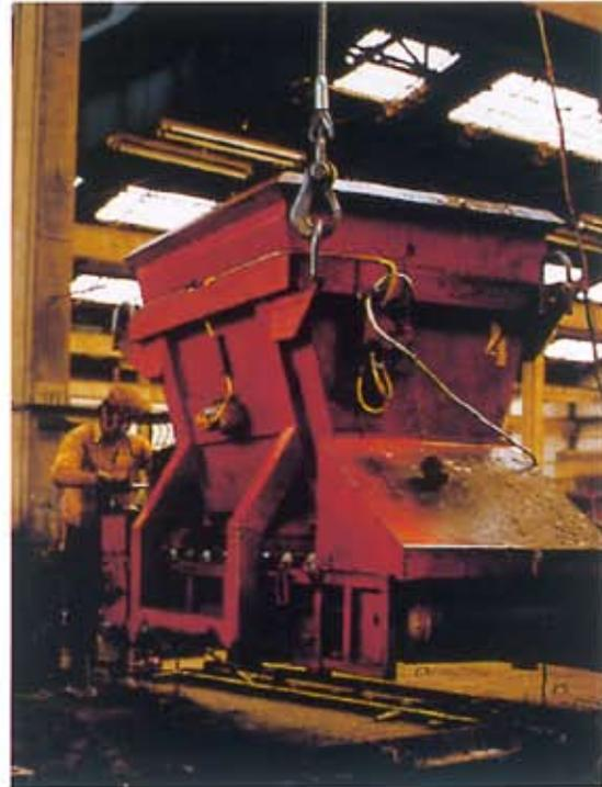
Figura 4.10 - Fôrma fixa com carro extrusor
