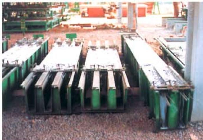
Figura 4.15 - Fôrma tipo "bateria"
