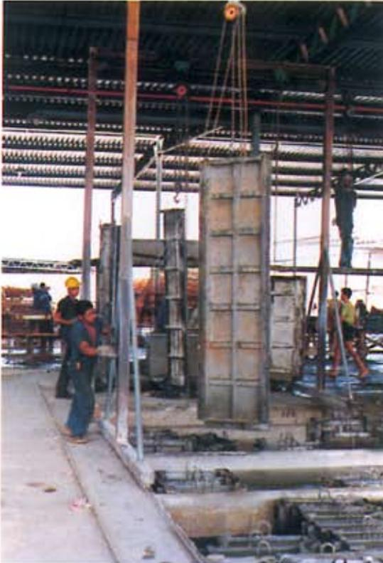
Figura 4.11 - Fôrmas móveis percorrendo uma linha de produção
