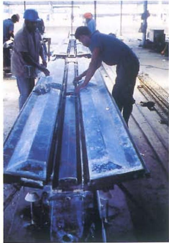
**Figura 4.6 - Limpeza e aplicação de desmoldante na formas**
