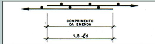
**Expressão para cálculo de comprimento da emenda,** transformada para as unidades utilizadas em nosso meio técnico ( $\phi > 8$  mm):
