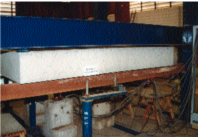
Foto 06.16 - Detalhe dos apoios articulados
