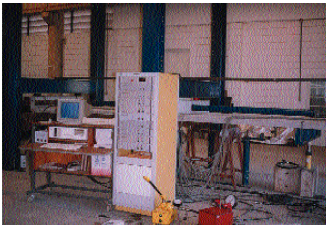
Foto 06.02 - Sistema de aquisição de dados e bombas hidráulicas
