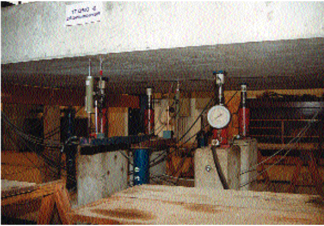
Foto 06.18 - Detalhe do sistema de aplicação do carregamento e do transdutor de deslocamento
