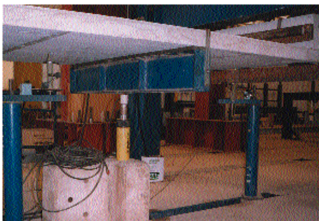
Foto 06.45 - Detalhe do dispositivo para aplicação do carregamento transversal
