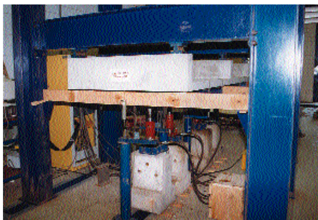
Foto 06.09 - Detalhe dos apoios articulados da viga
