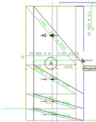
3- Copiar as telas para o lado do outro vergalhão alternado utilizando o comando COPY do sistema CAD.
